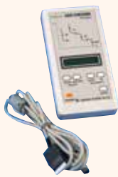
Aferidor de Relé de Proteção
